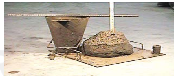
Consistenza S3: slump 100 - 150 mm
