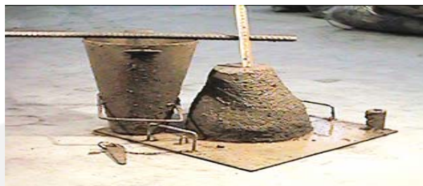
Consistenza S2: slump 50 - 90 mm
