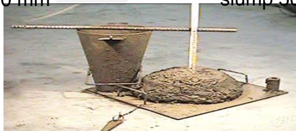
Consistenza S4: slump 160 - 200 mm
